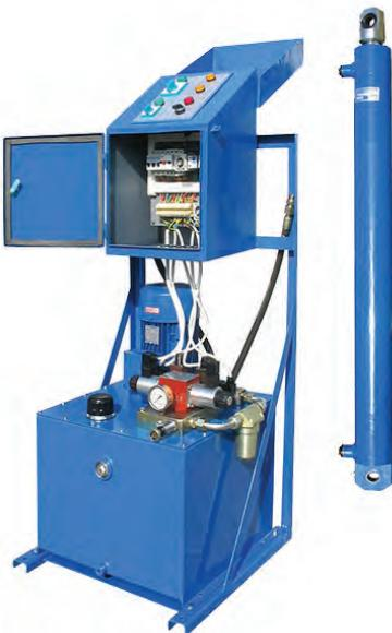
Aktuator za oscilatorna kretanja 90-0300 koristi se na mestima gde je potrebno da se obavljaju naizmenična kretanja sa fiksnom amplitudom koja odgovara hodu cilindra. Kretanje klipnjače cilindra može biti neprekidno bez zaustavljanja od jednog do drugog krajnog položaja klipnjače cilindra ili sa zadrškom (pauzom) u jednom od dva položaja. Kako se za promenu smera ne koriste krajni mikroprekidači to je moguća ugradnja u vrlo prljavim i vlažnim sredinama.
