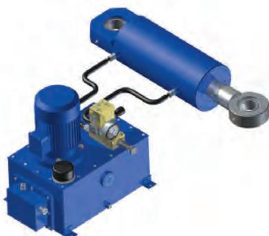
Aktuator je uređaj čija je osnovna namena ostvarenje velikih sila za kočenje koje se najčešće sreću za potrebe sidrenja kod velikih kranova. Pumpa pod pritiskom šalje ulje u komoru cilindra za uvlačenje i samim tim će se savladati sile opruge koja vrši sidrenje, kada je omogućeno kretanje krama. Sve vreme dok se kran kreće radi i hidraulični agregat koji sada svu količinu ulja pretače preko prelivnog ventila.
