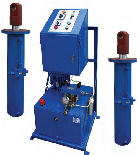
Tandem aktuator 90-0210 koristi se za sinhrono spuštanje ili podizanje tereta na određenu visinu i njegovo osiguranje u zadatom položaju. Brzina kretanja klipnjače cilindra se podešava i konstantna je bez obzira na pritisak u sistemu i teret koji deluje na istu.
